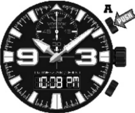
**Нажатие кнопки А** переключает 12/24 режим индикации цифрового дисплея.
