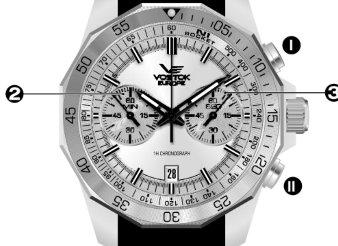
головку. Оттяните головку часов в крайнее положение (положение 2-ого щелчка) – ПОЗИЦИЯ «С» в момент, когда секундная стрелка «3» находится на цифре 60. Секундная стрелка остановится.
